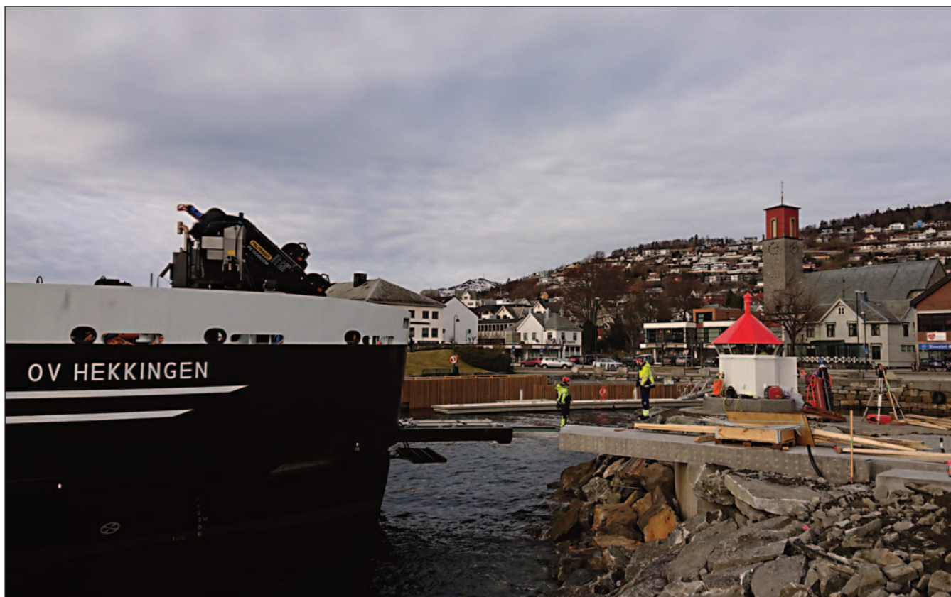
Kystverket setter lykta i operativ stand. OV Hekkingen er det nyaste og mest avanserte fartøyet til Kystverket. Med hybrid framdrift og permanente magnet-thrusterar vert bruk av drivstoff og klimautslepp langt lågare enn tidlegare.
